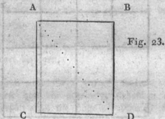
In dem Viereck ABCD heißt die Linie CB, welche von einer Ecke zur andern gezogen wird, die Diagonale.
