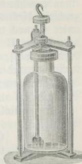
welche den Zweck haben, ein Herausstreten der Jodkaliumlösung zu vermeiden. In diese taucht das Rohr R so weit ein, daß die austretenden Gasblasen in den geschlossenen Theil des Absorptionsgefäßes, welches die Form einer umgekehrten Retorte besitzt, treten müssen. Ein Verlust ist somit ganz ausgeschlossen und vollständige Absorption gesichert.
