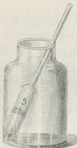
tretende bräunliche Färbung wieder verschwindet. Endlich vergeht dieselbe nicht mehr, und nun ist der Punkt erreicht, an welchem alles Silber ausgefällt ist. Bei einiger Uebung gelingt es jedesmal mit großer Schärfe jenen Punkt zu erfassen, an welchem der erste bräunliche Ton wahrnehmbar wird.
