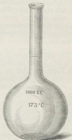
Verdünnen von Normallösungen u. s. w. Sie werden mit verschiedenem Fassungsvermögen angefertigt, am häufigsten werden Meßkolben mit einem Inhalte von 50, 100, 200, 250, 1000, 2000 und 5000 Cbcm. verwendet.
