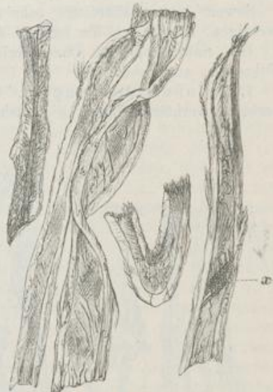
Aus Baumwollpapier. Baumwollhaare, verhältnissmässig gut erhalten, aus einem Filtrirpapier; links oben ein Haarstück, das einer Flachbastzelle, rechts ein ebensolches, das einer breiten Holzfaser ähnlich sieht.
