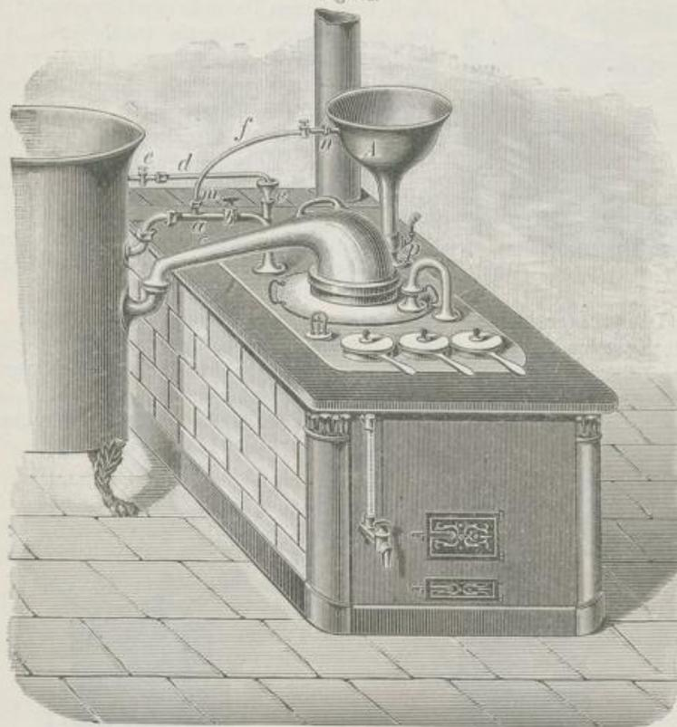
Arbeiten gleichzeitig ausführen zu können. FR. MOHR sorgte für eine bessere Ausnützung des Raumes, indem er trichterförmige Gefässe auf Stützen der Deckplatte des Apparates einfügte. Statt des gemauerten Ofens wurden Oefen ganz aus Gusseisen construirt, denen der Dampfapparat eingehängt wurde.
