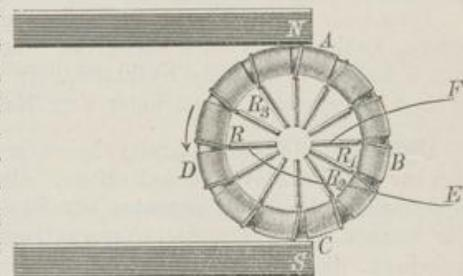
Das Eigenthümliche der dynamo-elektrischen Maschine liegt nun darin, dass die Magnete, welche die elektrischen Ströme induciren (s. Induction), durch diese Ströme selbst erzeugt werden. Man setzt nämlich an Stelle der Magnete Eisenbarren, um welche sich die von den Bürsten kommenden Drähte, ehe sie in die Nutzleitung gehen, derart herumwinden, dass durch die Wirkung eines Stromes, der in diesen Windungen circulirt, in den Eisenbarren die oben bezeichneten Pole entstehen.
