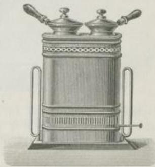
Zum Abzuge des überflüssigen Dampfes sind entweder kleine Oeffnungen im Dampfkessel angebracht oder derselbe ist durch ein Rohr mit dem innerhalb des Kessels vorhandenen Dampfmantel verbunden, aus welchem das condensirte Wasser in den Kessel zurückfliesst. Für Laboratoriumszwecke bedarf man grösserer Apparate. Ein Apparat, welcher allen später construirten Apparaten als Basis gedient hat, ist der nach seinem Erfinder BEINDORFF benannte Apparat (Fig. 62). Derselbe besteht
