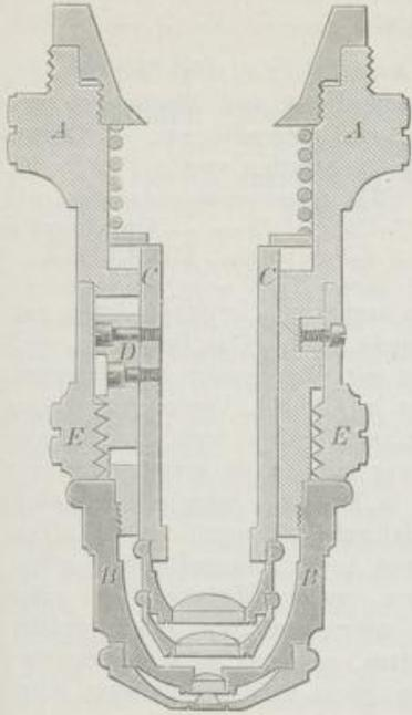
Um diesen Einfluss zu beseitigen, versieht man die gedachten Systeme, welche dann als **Correctionssysteme** bezeichnet werden, mit einer mechanischen Vorrichtung, welche es gestattet, die Entfernung zwischen den vorderen und hinteren Linsen in gewissen Grenzen abzuändern, das heisst für ein dem normalen gegenüber dickeres Deckglas dieselbe zu vermindern, für ein dünneres zu vergrössern.
