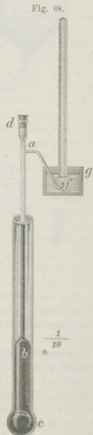
innerhalb und ausserhalb des Rohres gleich steht. Nach einiger Zeit liest man das Luftvolumen ab und notirt die Temperatur des Wassers und den Barometerstand. — Reicht die Siedetemperatur des Diphenylamins zur Verdampfung der Substanz nicht aus, so wendet man statt des Kolbens *c* einen offenen Tiegel und statt des Diphenylamins schmelzendes Blei an.
