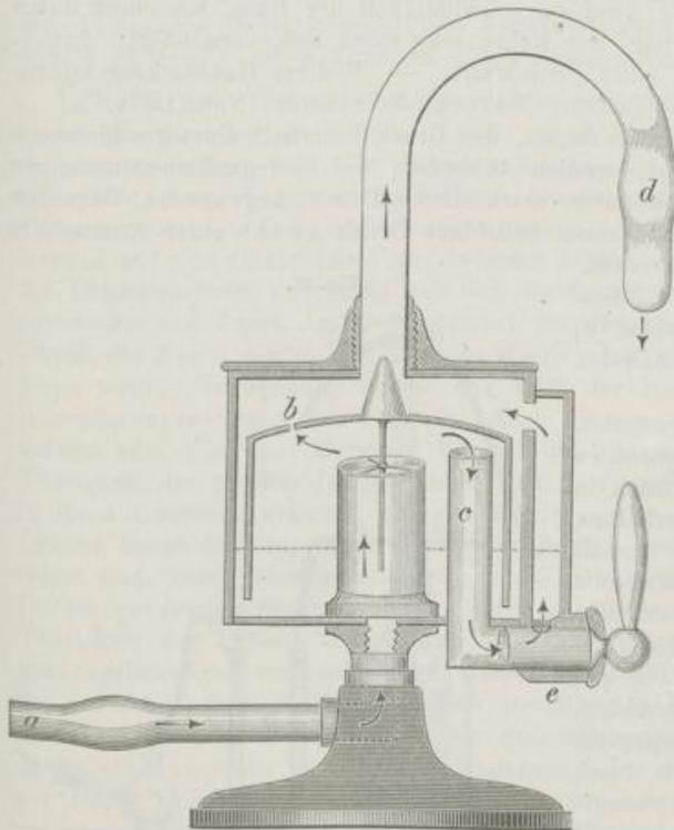
Um gewisse Heizvorrichtungen (z. B. bei Trockenschrank, Brutöfen, Wasserbädern etc.) auf constanter Temperatur zu erhalten, benutzt man sogenannte Thermoregulatoren (s. d.), welche aber nur dann zur Erzielung des gewünschten Resultates geeignet sind, wenn der Gasdruck nicht zu grossen Schwankungen unterliegt; handelt es sich daher um Erlangung ganz constanter Temperatur für längere Zeit hindurch, so
