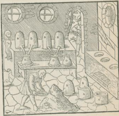
Fig. 43. Quecksilbergewinnung durch Destillation nach einem Holzschnitte vom Jahre 1557.
