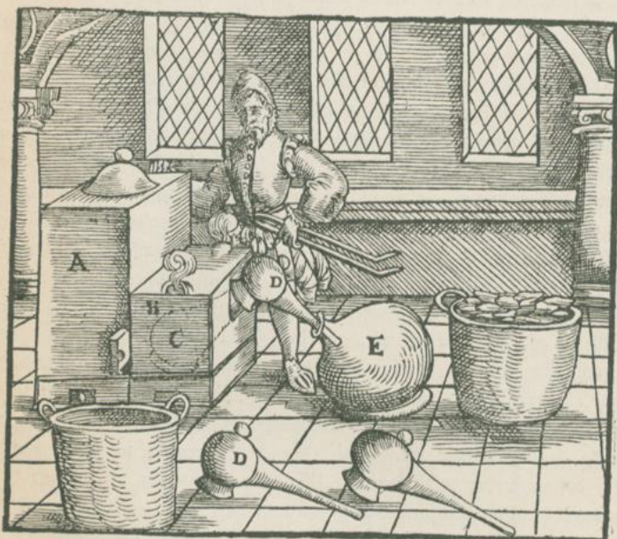
Fig. 57. Destillierung der Salpetersäure nach einem Holzschnitte vom Jahre 1598.
