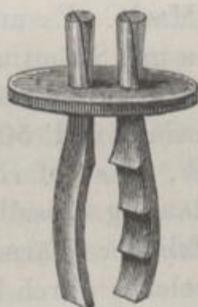
und Zersetzung desselben mittelst Natrium. Die Elektrolyse wird in einem, oben durch ein eingesetztes Stück Porcellan halbirten Porcellantiegel (Fig. 45) ausgeführt. Nachdem darin das Chlormagnesium zum Schmelzen gebracht ist, werden die in dem Deckel befestigten, aus Gaskohle gefertigten Polenden (Fig. 46) eingesetzt, und diese
