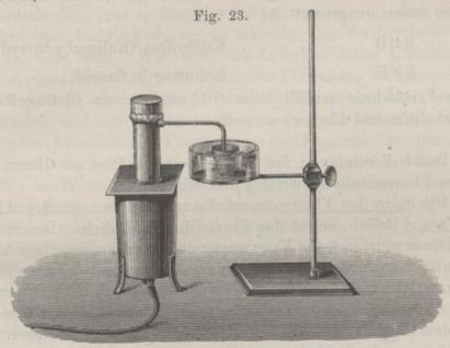
Das als Retorte dienende Gefäss ist ein Bleicylinder mit starkem, gleich einer Kappe übergreifendem Bleideckel, und mit seitlicher Durchbohrung zur Aufnahme des gebogenen Platinrohrs,
