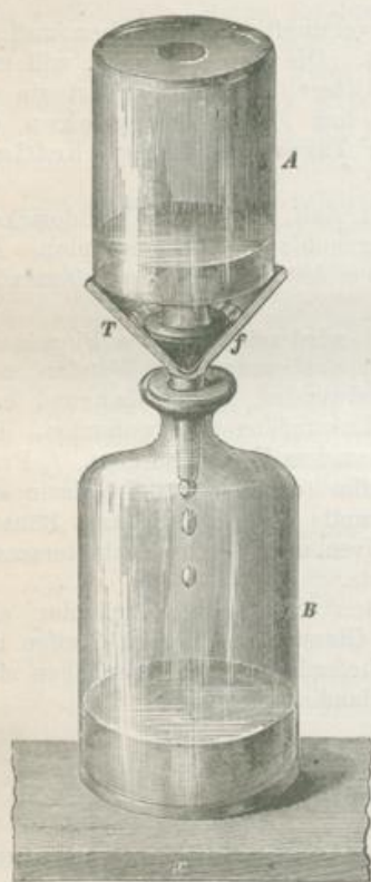
Filtermethode für flüchtige Flüssigkeiten. Der Trichter T mit kleinem Filter F wird über die Flasche A (mit der zu filtrierenden Flüssigkeit) gestülpt, dann das Ganze in fester Aneinanderlage schnell umgekehrt und mit dem Trichter C auf eine andere Flasche B gesetzt.
