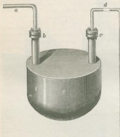
\frac{1}{5} – \frac{1}{2} Lin.-Grösse. Reductionsgefäss z. Darstellung d. Ferrum reductum nach WOEHLER.
