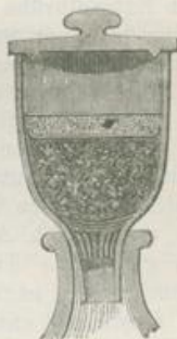
Durchschnittszeichnung eines beschickten Deplacir- trichters aus Steingutmasse.
