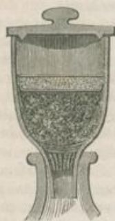
Durchs chnittszeichnung eines beschickten Deplacirtrichters aus Steingutmasse.
