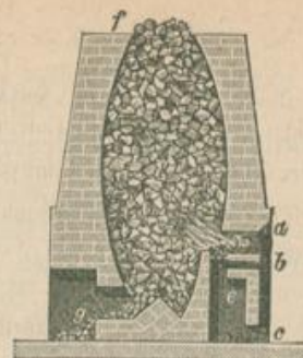
Höhendurchschnitt eines Kalkofens mit continuirlichem Betriebe.
