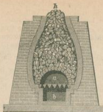
Höhendurchschnitt eines Kalkofens mit periodischem Betriebe.
