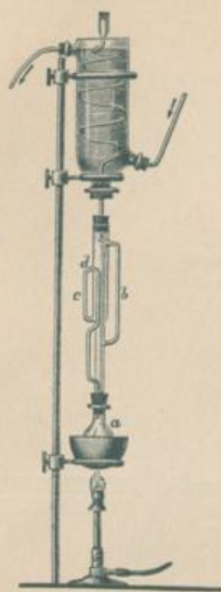
Soxhlet'scher Extractionsapparat nach Szombathi.
