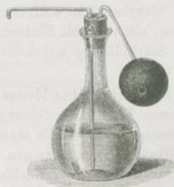
Einfüllen von Zinnchlorür in die Burette.
