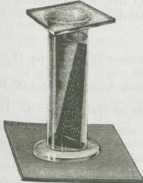
Reduction des Eisenoxys zu Oxydul.
