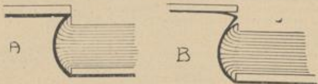
Fig. CXI. A. Richtige Holzform beim fertigen, trockenen Lederbezug. B. Schlechte Holzform Entsteht durch schlechtes Anbinden des Deckels an den Rücken, beim Zullappen des eingeschlagenen Buches oder durch zu dickes Leder im Holz.
