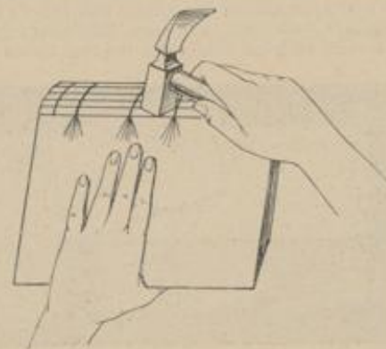
Fig. LXIV. Haltung von Buch und Hammer beim Runden des Buches.
