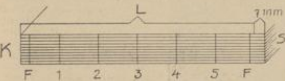
Fig. XXXVI. Einteilung eines beschnittenen Buches für flexible Festung auf fünf Bände. K. Kopf, S. Schwanz des Buchrückens. F. Festschnüre. 1-5. Markierung für fünf Schnüre. L. Länge zum Teilen in sechs gleiche Teile.
