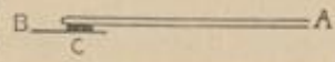
Fig. XVI. Verbinden der Tafeln mit dem Papierstreifen. A. An den Enden des Buches beim Gebrauche am stärksten strapaziert werden. C. Klebestelle.
