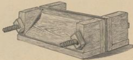
Fig. IX. Klapppresse zum Vergolden der Bücher.
