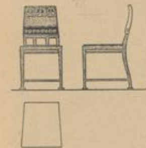
Nr. 96. Vorder- und Seitenansicht eines Stuhles und Grundriß des Sitzes. (1/20 der natürlichen Größe.)
