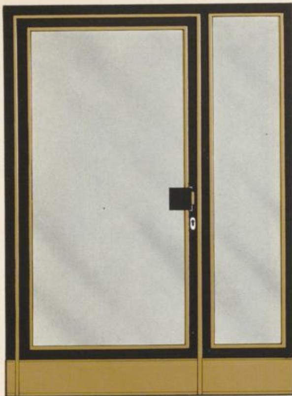
Anbauteile auf Wunsch rechts, links oder beidseitig. Breite eines Anbauteiles 450 mm.
