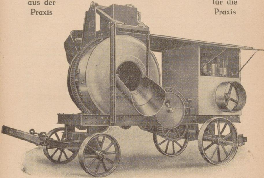
Einheits-Beton-Mischmaschine „System Gross“
