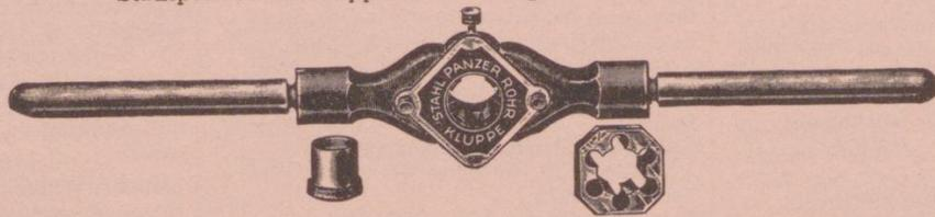
Rohrgewinde-Schneidkluppen der verschiedenen Systeme:
