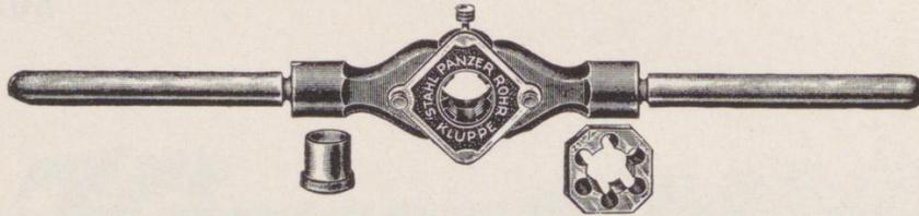
Rohrgewinde-Schneidkluppen der verschiedenen Systeme:
