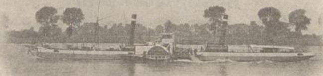
Radschlepper Hugo Stinnes No. 1, 1500 PS., stärkster Schleppdampfer auf dem Rhein.
