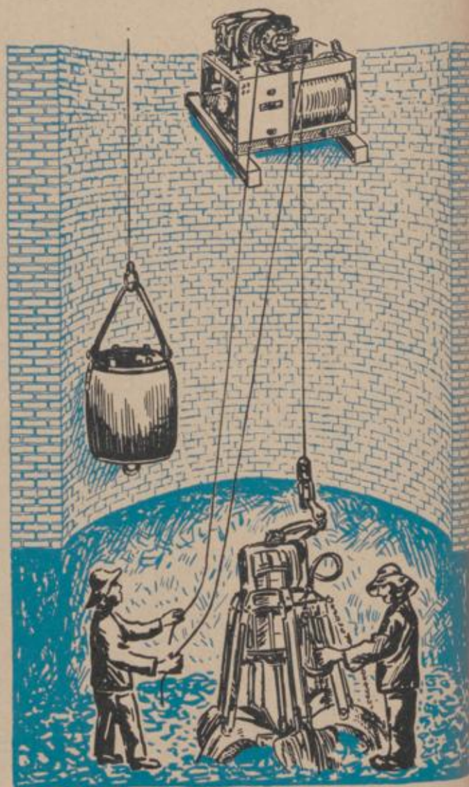
Abteufen am langen Seil mittels Greifer und Winde
