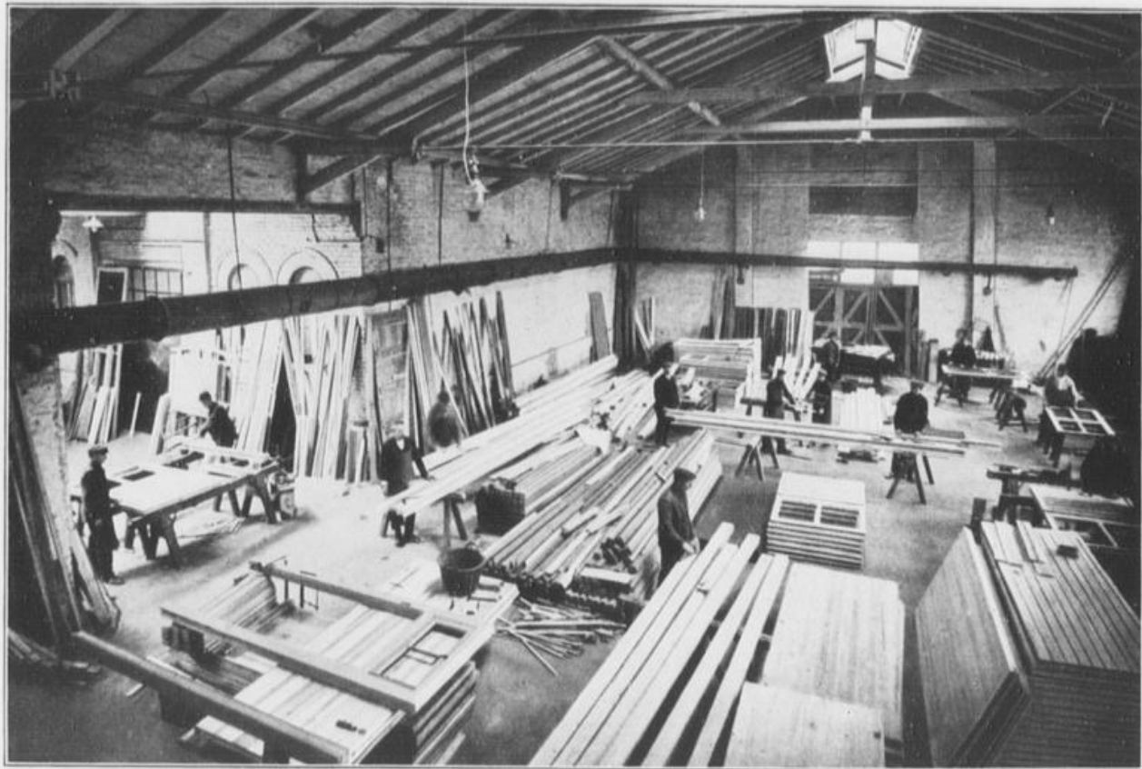
Arbeitsaal zur Herstellung von Holzhaus-Bautafeln.
