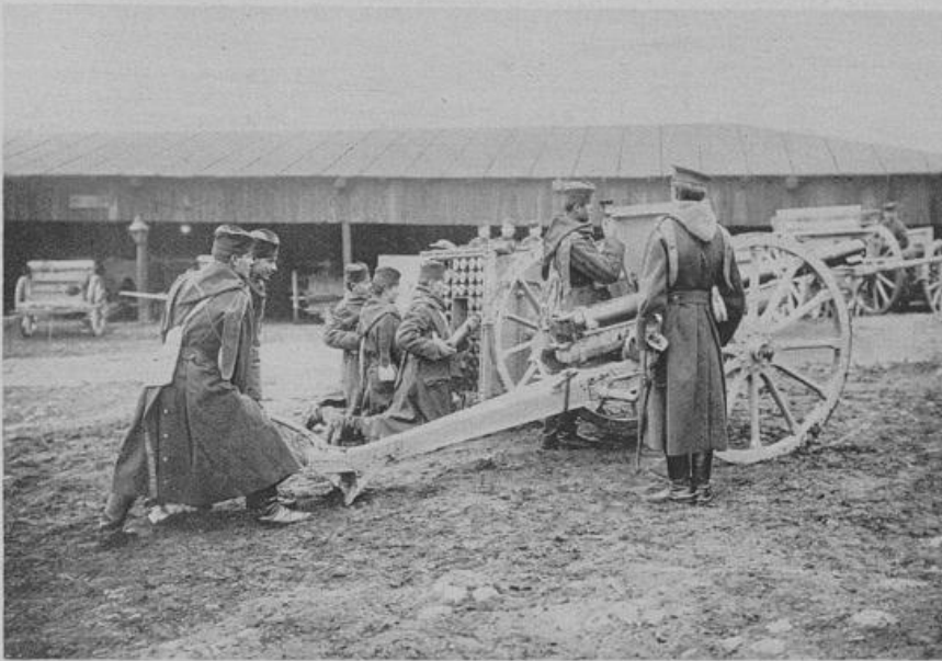
Serbische Artilleristen beim Achten einer Schnellfeuerkanone mit Rohrrücklauf und Schußschilden.
