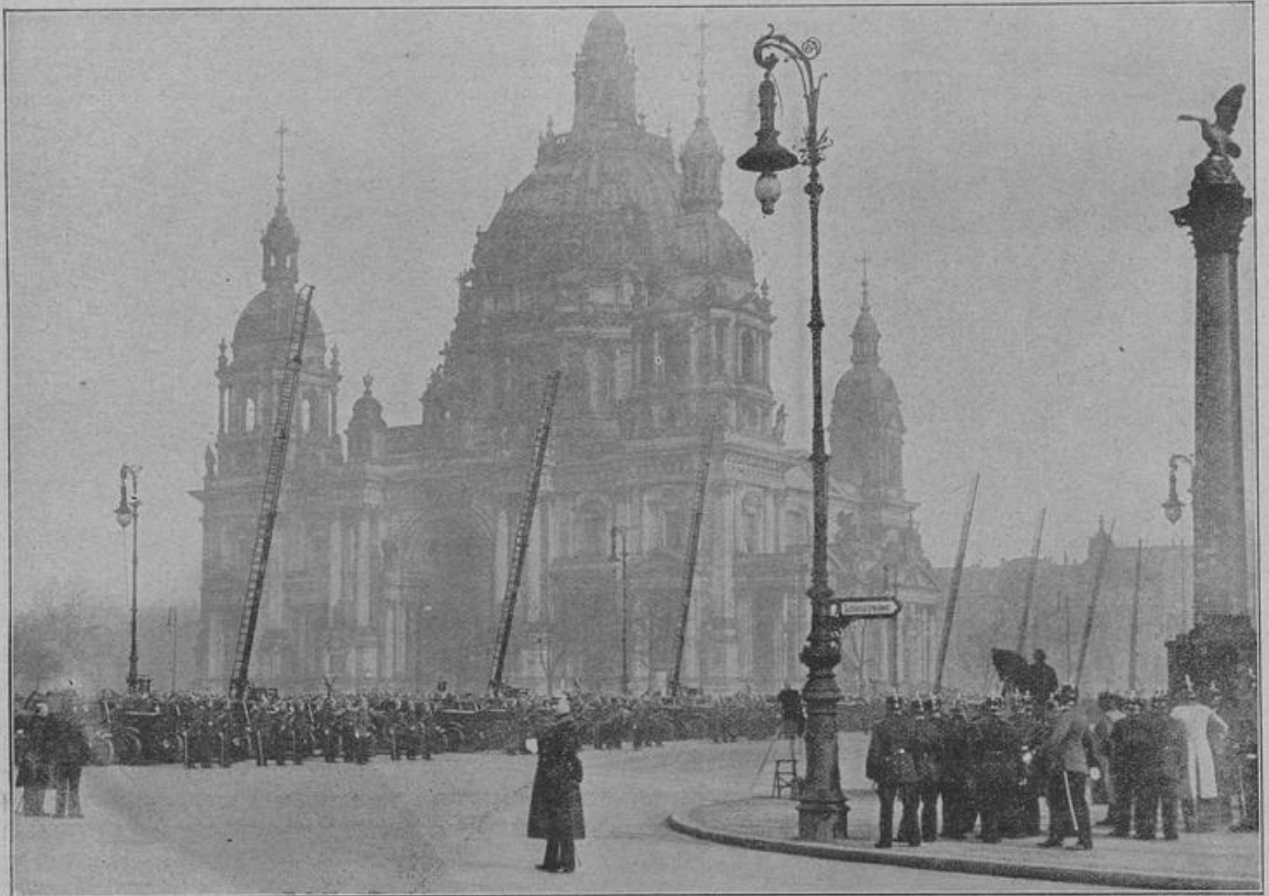
Feuerwehrrübung vor dem Kaiser in Berlin: Die zwischen Schloß und Dom aufgestellten Motorfahrzeuge mit Maschinenleitern.
