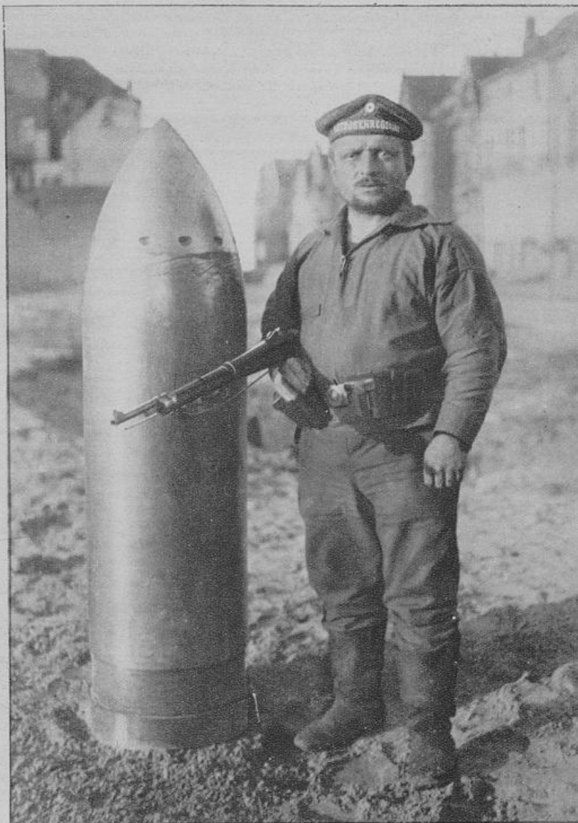
Englische Stahlgranate, nicht explodiert, bei der Beschießung von Middellerte-Westende. Kaliber 38,5 cm, Länge 138 cm, Gewicht 14 Zentner.
