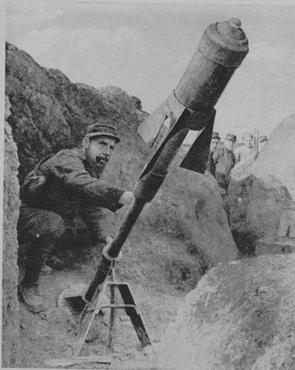
Abfeuern eines Lufttorpedos mit einer Vorrichtung älterer Bauart.
