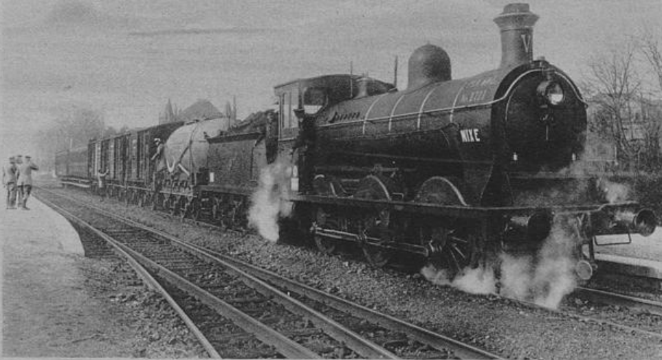
Badegelegenheit für unsere Soldaten in der vordersten Front: Der Badezug des 1. bayr. Reservekorps. Der Zug besteht aus der Lokomotive, dem Wasserwagen, drei Badewagen, einem An- und Ausleidewagen und einem Wohnwagen für das Personal des Zuges. Das Wasser wird durch den Dampf der Lokomotive erhitzt und auch mittels Dampfes in die Badewagen gedrückt. Phot. W. Braemer, Berlin.
